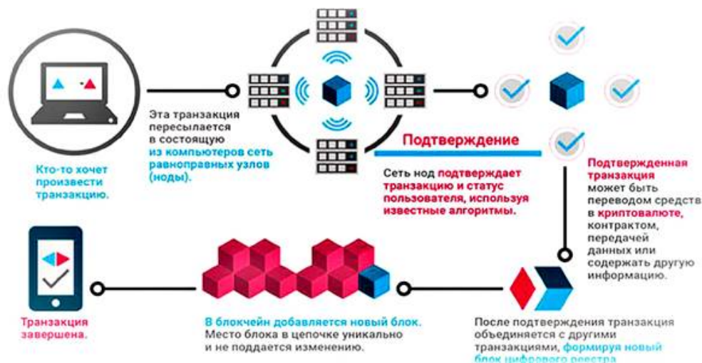
Рис. 1. Общий алгоритм функционирования блокчейн-сети (сообщества). Fig. 1. General algorithm for the functioning of a blockchain network (community).
